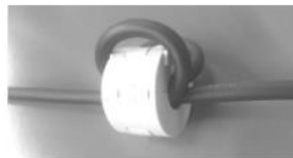
図 45 - リング状フェライトコア(取付け例)
